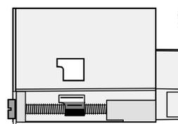
2. Gerät bis zum Anschlag in den Sockel einstecken. Die Bezeichnung „TOP“ muss oben sein!
