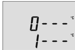
1---°C = Fühler Wärmelieferant (z.B.Kollektor oder Feststoffkessel) hat Kurzschluss
