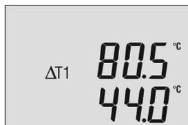
80.5°C= Temperatur Wärmelieferant (z.B.Kollektor oder Feststoffkessel)
