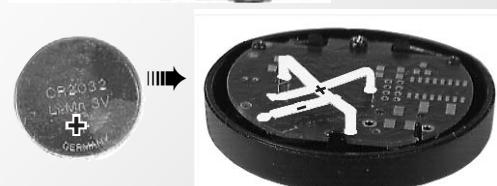
Cuando aparece en el visualizador durante la medición **■** debe cambiarse la pila. Abrir la tapa utilizando un destornillador. Sacar la pila tipo botón gastada. Colocar una nueva pila. **Respete la polaridad!**
