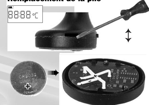
Si le signal apparaît pendant la mesure, ouvrez l'appareil à l'aide d'un tournevis.
