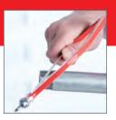
Gewinde mit einem Sägeblatt oder einer Feile anrauen.
