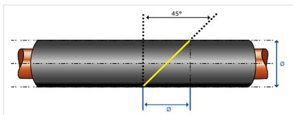
**Hinweis:** Gelbe Linie zeigt den Schnittverlauf. Für einen exakten Schnittwinkel bitte die ArmaFlex Schneideschablone auf dem Schlauchkarton benutzen.
