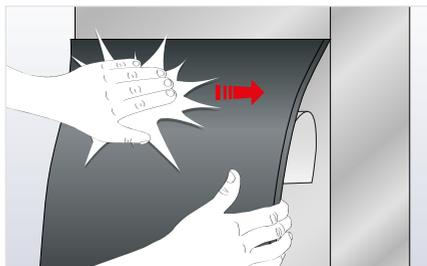
Die Schutzfolie 10 bis 20 cm abziehen und die ArmaFlex Platte gerade ansetzen. Fest andrücken, um den Kleber zu aktivieren.
