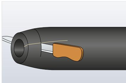
3. Schlauch auf der schmalere Seite auf die Größe der kleineren Dimension kürzen. Danach den Schlauch von der anderen Seite her auf die erforderliche Länge kürzen und den Schlauch der Länge nach aufschneiden.
