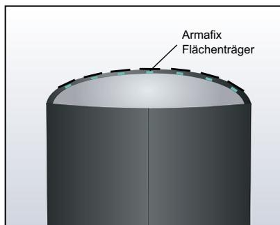
Flächenträgerstreifen der Bogenlänge des Behälterkopfes entsprechend ablängen. Danach erfolgt eine mittig gelegene Positionierung mittels beidseitiger und vollflächiger Verklebung mit ArmaFlex Verklebungssystemen.
