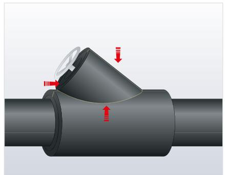
Formteil ausscheiden und dort anschrägen, wo es am Ventilkörper anliegt. Längsnaht dünn mit ArmaFlex Kleber einstreichen und ablüften lassen. Formteil über Spindelrad schieben und Teile dicht miteinander verkleben.
