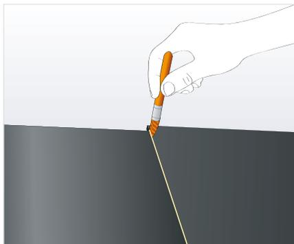
Durch das Hineinpressen der überstehenden Stoßkante wird das Material nicht in die Länge gezogen, sondern auf Druck verklebt.
