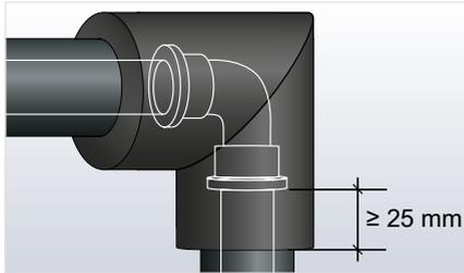
ArmaFlex Schlauch bis an das Fitting heranzuführen und auf dem Rohr festkleben.
