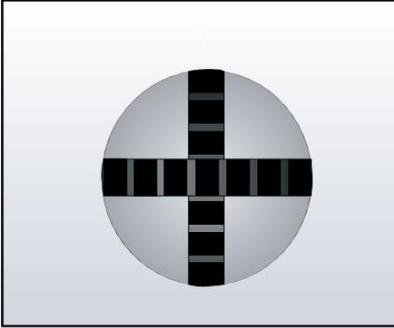
Bei kleinen Behältern ( $< 1000 \text{ mm } \varnothing$ ) wird generell eine kreuzförmige Anordnung empfohlen. Bei großen Behältern können mehrere Flächen-trägerstreifen radialsymmetrisch angeordnet werden. Die Anordnung kann aber auch der jeweiligen Anforderung entsprechend individuell ausgeführt werden.
