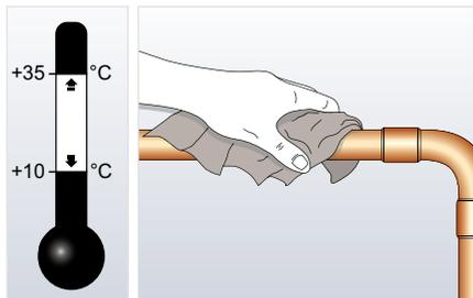
Die Rohrleitungen zunächst mit ArmaFlex Spezialreiniger von Staub, Schmutz, Öl und Wasser befreien. Die selbstklebenden Schläuche bei Umgebungstemperaturen zwischen +10 und +35 °C verarbeiten.
