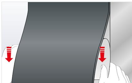
Die Schutzfolie nach und nach ablösen. Dabei die ArmaFlex Platte auf der Oberfläche korrekt ausrichten und fest andrücken. Stoßnähte für Verarbeitung auf Druck 5 mm überlappen lassen. Um ein überlappendes Ansetzen zu ermöglichen, ist hierzu vorher am zu verklebenden Plattenrand ein ca. 30 mm breiter Streifen der Abdeckfolie wieder anzukleben.
