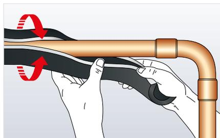
Geschlitzte ArmaFlex Schläuche über die Rohrleitungen stülpen. Die Abdeckfolie der Selbstklebebeschichtung im Vorfeld nicht entfernen.
