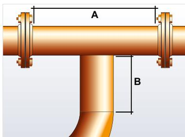
2. Die Länge A des Hauptrohrs und die Länge B des abzweigenden Rohrs ausmessen.
