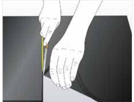
**Vorsicht:** Den Streifen nicht ziehen, da sonst ein zu kleiner Umfang ermittelt wird. Dies führt zu großen Spannungen auf den Nähten.
