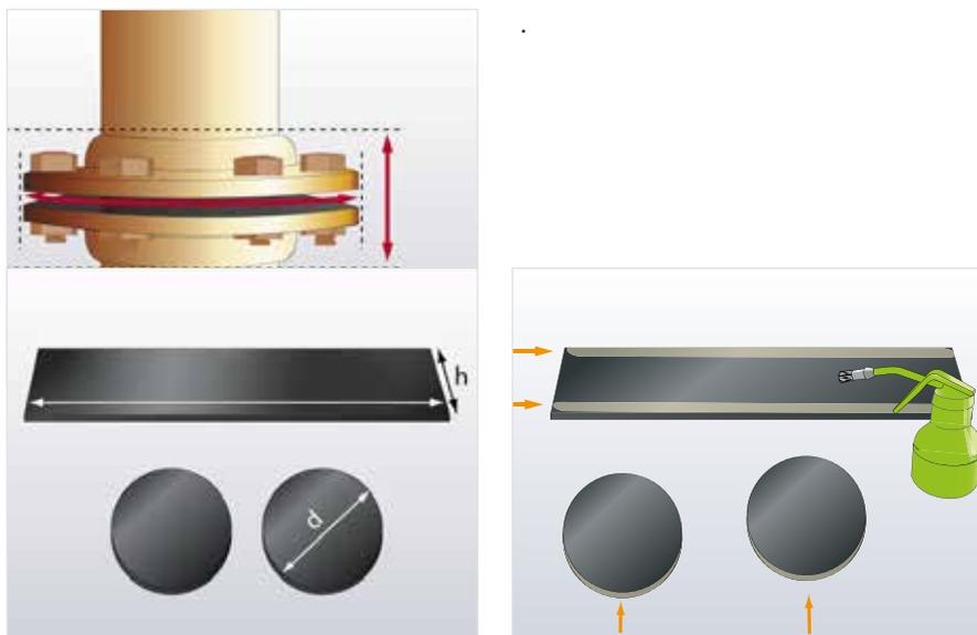
Mittels des Durchmessers ( $d$ ) mit einem Zirkel zwei konzentrische Kreise auf eine ArmaFlex Platte übertragen und die beiden Stirnscheiben ausschneiden.
