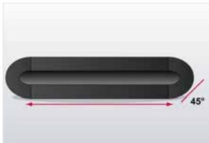
1. Ungeschlitzten ArmaFlex Schlauch in der Dämmschichtdicke der Kanaldämmung verwenden. Mit einem scharfen Messer den Schlauch in zwei gleichgroße Hälften teilen.
