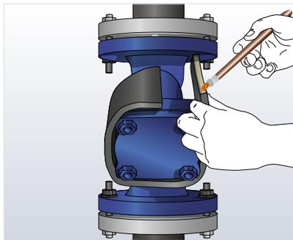
4. Den Umfang auf eine ArmaFlex Platte übertragen und die Mittellinie markieren.
