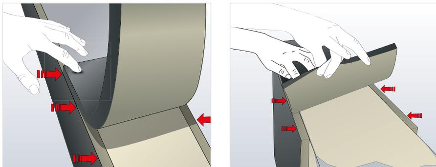
Nach dem Ablüften (Fingerprobe) die ArmaFlex Platte anlegen und fest andrücken, um einen guten Halt zu erzielen. In der beschriebenen Abfolge Kleber auf beide Oberflächen einschließlich der ArmaFlex Kanten auftragen, ablüften lassen und fest andrücken.
