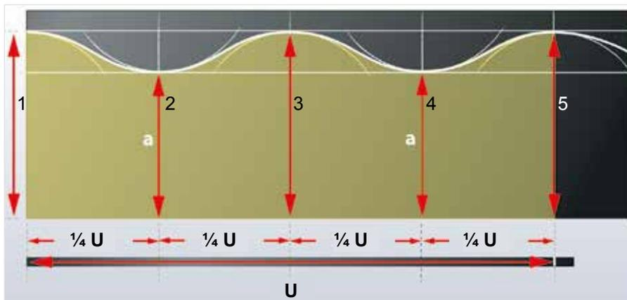
Durch die Viertelteilung des Umfanges sind fünf Linien entstanden. Mit dem Zirkelmaß des Radius des gedämmten Ventilkörpers sind zunächst zwei Kreise senkrecht auf dem oberen Endpunkt der Strecke  $a$  zu erstellen. (2. und 4. Linie von links)
