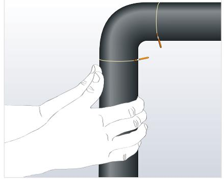
Das Formteil über den Rohrbogen legen. Den Kleber ablüften lassen und dann die Klebeflächen fest zusammendrücken.
