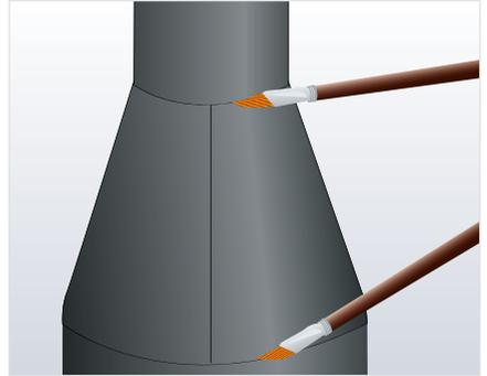
Längsnaht dünn mit ArmaFlex Kleber einstreichen, ablüften lassen und zunächst an einem Ende, dann am gegenüberliegenden Ende zusammendrücken. Von der Mitte aus die Naht nun vollständig verschließen.
