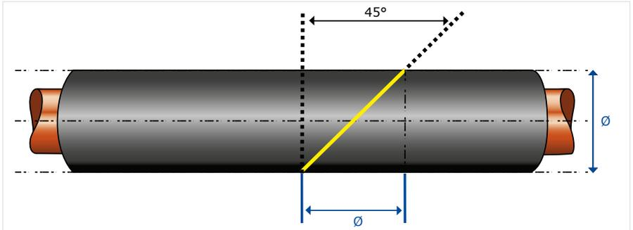
**Hinweis:** Gelbe Linie zeigt den Schnittverlauf. Für einen exakten Schnittwinkel bitte die auf jedem Schlauchkarton aufgedruckte ArmaFlex Schneideschablone verwenden.
