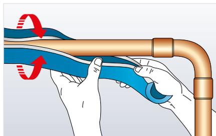
Geschlitzte ArmaFlex Ultima Schläuche über die Rohrleitungen stülpen. Die Abdeckfolie der Selbstklebebeschichtung im Vorfeld nicht entfernen.
