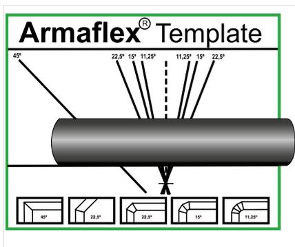
Zur Herstellung von Formteilen aus Schlauchmaterial müssen je nach Umfang, Durchmesser und Radius die Schlauchstücke in unterschiedliche Winkel geschnitten werden. Zur einfacheren Herstellung dieser Formteile ist auf jedem ArmaFlex Karton eine ArmaFlex Schneideschablone aufgedruckt.
