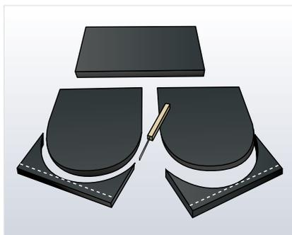
Anhand dieser Abmessungen zwei Stirnplatten und eine Frontplatte auf die ArmaFlex Platte aufzeichnen. Angezeichnete Formstücke mit einem scharfen Messer ausschneiden.
