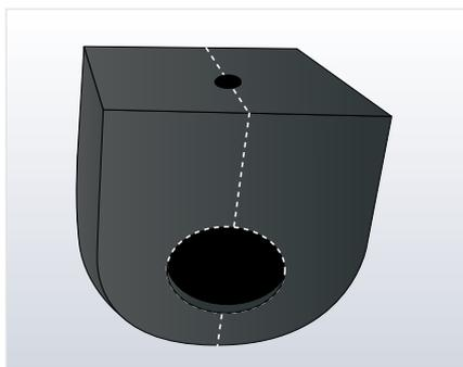
Je einen Ausschnitt mit dem Durchmesser der angrenzenden gedämmten Rohrleitung auf Stirnplatten anzeichnen und ausschneiden. Danach Ausschnitt für die Ventilspindel im Bereich der Frontplatte vornehmen. Box im Frontbereich ausschneiden, Nähte beidseitig dünn und gleichmäßig mit ArmaFlex Kleber einstreichen. Nach der Ablüftezeit die Box montieren, Nähte dabei sorgfältig zusammendrücken. Nähte im Bereich der Ausschnitte durch Nassverklebung schließen.
