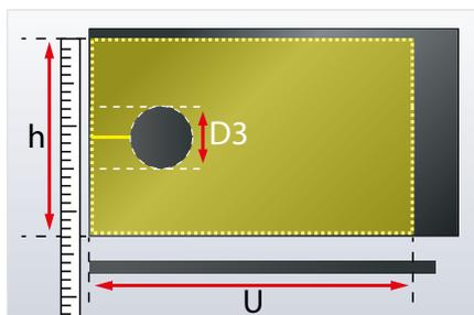
**Hinweis:** Bei Ventilspindeln ohne Flanschanschluss wird empfohlen, die Ausschnitte so zu platzieren, dass sie im ersten Viertel der ArmaFlex Platte liegen.
