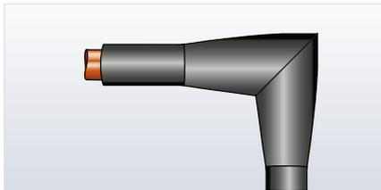
1. Die Abdeckung des Verbindungsstücks wird aus Schlauchmaterial gefertigt, dessen Innendurchmesser dem maximalen Außendurchmesser des Schraubfittings entspricht. Auf beiden Seiten mindestens 40 mm Überlappung über das Ende des Verbindungsstücks hinaus vorsehen.
