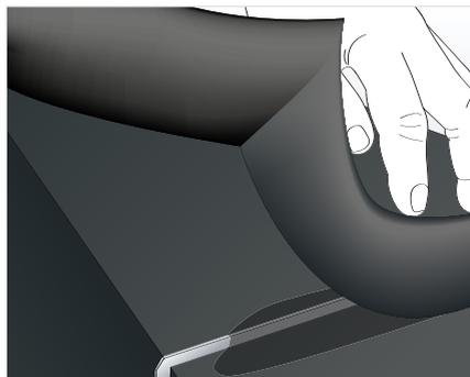
7. Die Flanschdämmung aus ArmaFlex Schläuchen im Bereich der Kanalflanschung fachgerecht verkleben.
