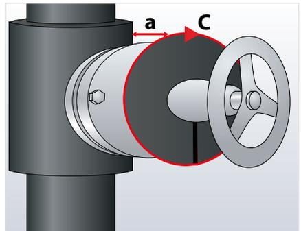
Die Stirnscheibe an einer Seite aufschneiden, Kleber auf die Schnittflächen auftragen und ablüften lassen. Die Stirnscheibe über dem Spindelhalbs platzieren und die Klebenahrt schließen. Umfang (U) der Stirnscheibe mit einem entsprechenden ArmaFlex Streifen messen und die Messungen auf ArmaFlex Platte übertragen. Höhenmaß (a) ebenfalls auf ArmaFlex Platte übertragen.
