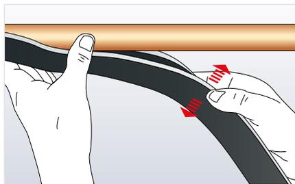
ArmaFlex so auf der Rohrleitung positionieren, dass die geschlitzte Fläche zugänglich ist.
