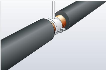
1. Die ArmaFlex Dämmung so dicht wie möglich an die Rohrschelle heranführen. Die Enden der Dämmung durch Abschottungsverklebung mit der Rohrleitung verbinden.
