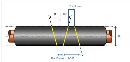
**Hinweis:** Gelbe Linie zeigt den Schnittverlauf. Für einen exakten Schnittwinkel bitte die ArmaFlex Schneideschablone auf dem Schlauchkarton benutzen.
