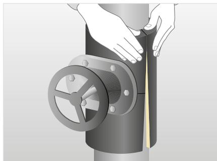
Nähte des ausgeschnittenen Formteils mit ArmaFlex Kleber einstreichen. Ablüften lassen (Fingerprobe), ausrichten und fest zusammendrücken.
