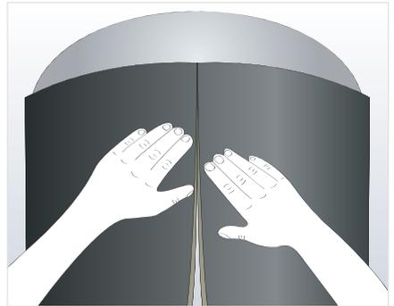
2. Den Umfang auf eine ArmaFlex Platte übertragen und passgenau zuschneiden. Eine dünne Schicht Kleber auf die ArmaFlex Platte und dann auf die Metalloberfläche auftragen. Nach dem Ablüften (Fingerprobe) die ArmaFlex Platte anlegen und fest andrücken, um einen guten Halt zu erzielen. Die ArmaFlex Mantelplatte zur Verklebung ca. 10 bis 20 cm (abhängig von der Behältergröße) über der Schweißnaht im Bereich der Rundung des Behälterkopfes ansetzen.
