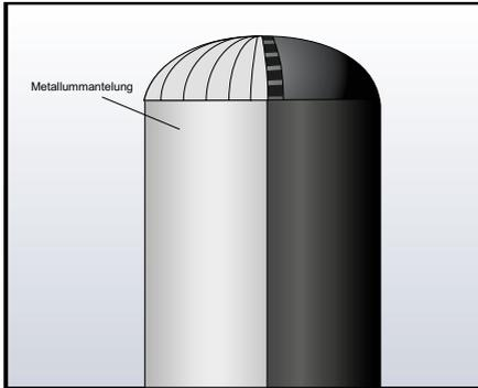
Die verbleibenden Flächen des Behälterkopfes zwischen den verklebten Flächen-trägerstreifen sind mit ArmaFlex Plattenmaterial vollflächig zu dämmen. Die Zugschnitte sind in allen ermittelten Maßen mindestens 5 mm größer auszuführen um eine „Auf-Druck-Verarbeitung“ zu gewährleisten. Das Bild zeigt zusätzlich die abschließende partielle Verblechung mit deutlicher Auflagerung auf dem Flächen-trägersystem.
