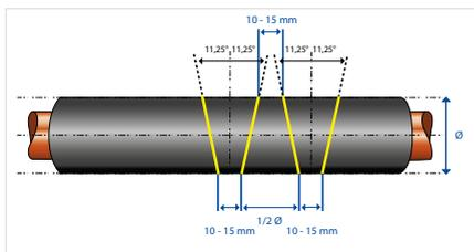
**Hinweis:** Gelbe Linie zeigt den Schnittverlauf. Für einen exakten Schnittwinkel bitte die ArmaFlex Schneideschablone auf dem Schlauchkarton benutzen.
