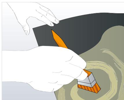
Eine dünne Schicht Kleber auf die Metalloberfläche und dann auf die ArmaFlex Platte auftragen.
