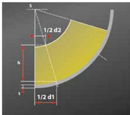
Die Messwerte wie dargestellt auf eine ArmaFlex Platte übertragen. Um den Materialverschnitt zu reduzieren nur eine Trapezhälfte am Plattenrand aufzeichnen.
