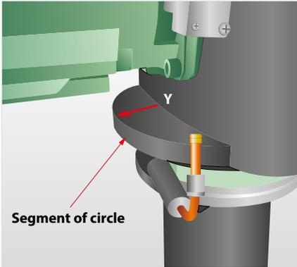
Zwei Flanschdecken anfertigen. Hierzu den Durchmesser der Flansche  $d_1$ , den Umfang  $U_2$ , die Höhe  $H_2$  und die Ausschnitte für die Verbindungen zu den gedämmten Rohren ermitteln.
