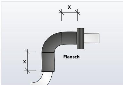
6. Das Formteil über den Rohrbogen legen. Den Kleber ablüften lassen und dann die Klebeflächen fest zusammendrücken.
