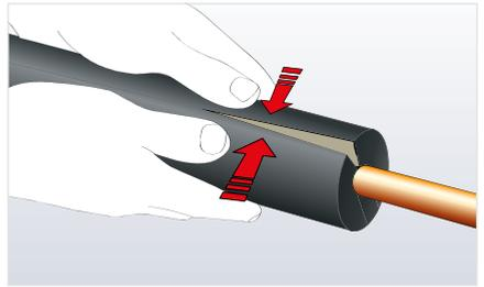
3. Kleber ablüften lassen, mittels Fingerprobe überprüfen.
