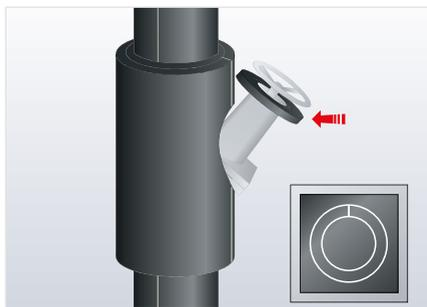
Längsnaht dünn mit ArmaFlex Kleber einstreichen, ablüften lassen, Formteil um den Ventilkörper legen und Nähte zusammendrücken.
