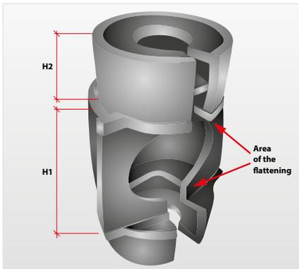
Das Bild zeigt eine Pumpenkappe mit gerader Frontplatte und halbrunden Mantel.
