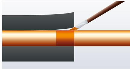
1. Insbesondere bei Kälteisolationen die Schlauch- oder Plattenenden ringsum fest mit der Rohroberfläche verkleben.
