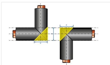
**Hinweis:** Gelbe Linie zeigt den Schnittverlauf. Für einen exakten Schnittwinkel bitte die ArmaFlex Schneideschablone auf dem Schlauchkarton benutzen.
