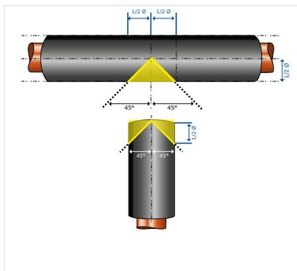
1. Das Schlauchstück der abzweigenden Leitung wird am Endstück mit Hilfe einer Gehrungslade oder der ArmaFlex Schneideschablone von der Mittellinie ausgehend zu einem Winkel von jeweils  $45^\circ$  geschnitten.
