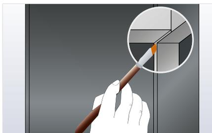
Die Stoßnaht auf Druck durch Nassverklebung schließen.
