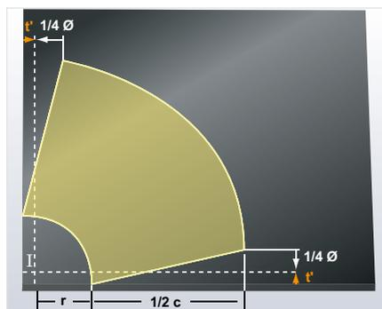
Am Rande einer entsprechenden ArmaFlex Platte zunächst in Breite der Dämmschichtdicke (t) eine horizontale und vertikale Linie anzeichnen und vom Schnittpunkt den zuvor ermittelten Innenradius (r) übertragen.
