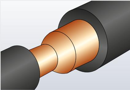
1. Zur Dämmung des Reduzierstückes zwischen zwei Rohren unterschiedlichen Durchmessers sollte genügend Platz gelassen werden.
