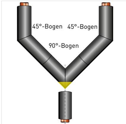
**Hinweis:** Gelbe Linie zeigt den Schnittverlauf. Für einen exakten Schnittwinkel bitte die ArmaFlex Schneideschablone auf dem Schlauchkarton benutzen.
