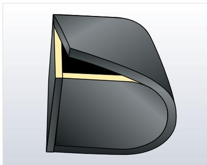
ArmaFlex Kleber wie oben dargestellt auftragen. Die Mantelfläche behutsam um die beiden Stirnplatten legen, so dass ein Gehäuse entsteht. Dabei darauf achten, dass die Kanten ohne Versatz übereinander liegen. Nähte fest zusammendrücken.
