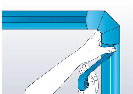
Für höhere Sicherheit ist es notwendig, die Längsstöße der selbstklebenden ArmaFlex Ultima Schläuche zusätzlich mit ArmaFlex Ultima Klebeband zu schützen. Hierbei muss die Oberfläche sauber, trocken und frei von Verunreinigungen sein. Wenn nötig vorher mit ArmaFlex Reiniger säubern.
