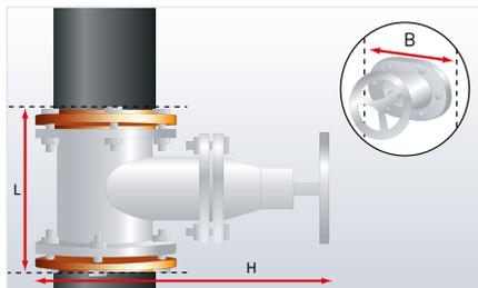
L = Länge des Ventils inklusive Flansche + 2 x Dämmschichtdicke
