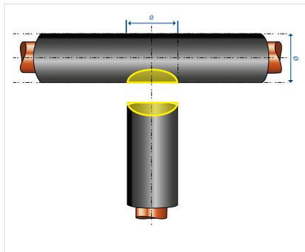
1. Mit dem angeschärften Ende eines Kupferrohrs passenden Durchmessers eine Öffnung in das Schlauchstück für die Hauptleitung schneiden.
