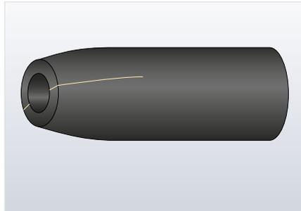
2. Aus einem Schlauchstück des größeren Durchmessers zwei gleich große, gegenüberliegende Keile herauschneiden und Schnittflächen miteinander verkleben, so dass sich der Schlauchdurchmesser reduziert.
