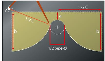
Umfang der Stirnscheibe mithilfe eines ArmaFlex Streifens ermitteln und ArmaFlex Platte entsprechend zuschneiden. Mittellinie einzeichnen.
