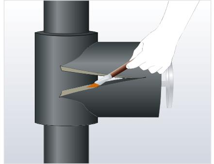
An den höchsten Stellen des Stutzens ist jeweils eine Anchrägung vorzunehmen, um eine optimale Anpassung an die Ventilmanteldämmung zu erreichen. Auf der Längsnaht Kleber auftragen, ablüften lassen, um das Spindelgehäuse legen und verkleben.
