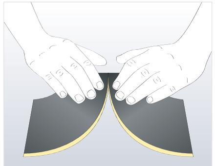
Formstücke zusammenlegen und die äußeren Schnittflächen dünn mit dem ArmaFlex Kleber einstreichen. Nach der Ablüftezeit des Klebers die beiden Hälften an einem Ende zusammenkleben.
