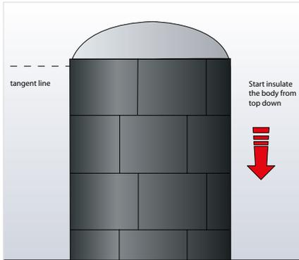
Die ArmaFlex Platten wie gezeigt vom Behälterkopf ausgehend nach unten anbringen. Dämmung immer vollflächig auf dem Behälter verkleben.
