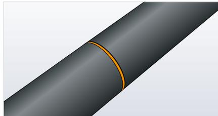
3. Für die abschließende Nassverklebung der auf Druck zusammengeführten Schlauch- oder Plattenenden werden die Stoßnähte mit den Fingern leicht auseinander gezogen und die Enden beidseitig mit den ArmaFlex Klebern dünn und gleichmäßig eingestrichen.
