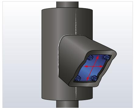
11. Eine Mittellinie anzeichnen und den Ausschnitt für den Siebteil markieren. Das Formteil ausschneiden und Kleber auf die Längsnaht auftragen. Die Dämmung mit ArmaFlex Kleber am Schmutzfängerkörper anbringen.
