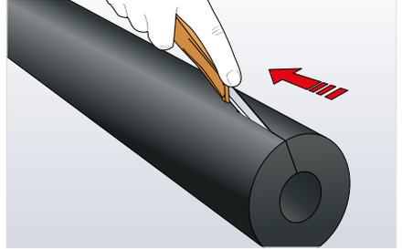
Ein scharfes Messer verwenden. Beim Schlitten des Schlauchs das Messer mit einem kleinen Winkel zur Schneidefläche führen.
