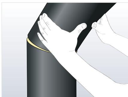
Erst die Längsnaht und dann die Verbindungsnaht mit ArmaFlex Kleber verkleben.
