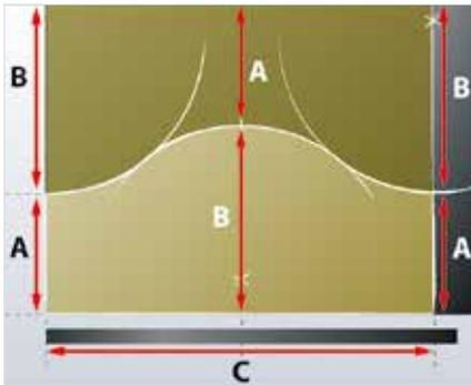
Den Umfang auf eine ArmaFlex Platte übertragen und Mittellinie einzeichnen.
