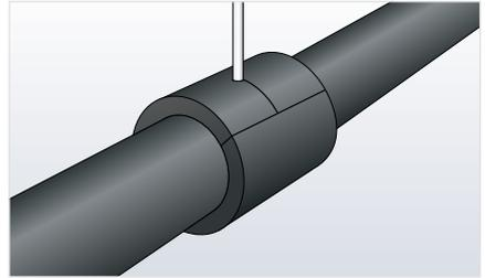
3. Dämmung um den Bereich der Schelle montieren und alle Nähte dicht verkleben, insbesondere den Durchdringungsbereich der Gewindestange.
