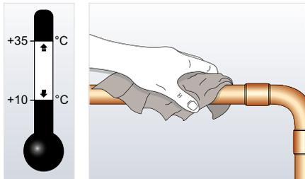
Die Rohrleitungen zunächst mit ArmaFlex Spezialreiniger von Staub, Schmutz, Öl und Wasser befreien. Die selbstklebenden Schläuche bei Umgebungstemperaturen zwischen +10 und +35 °C verarbeiten.
