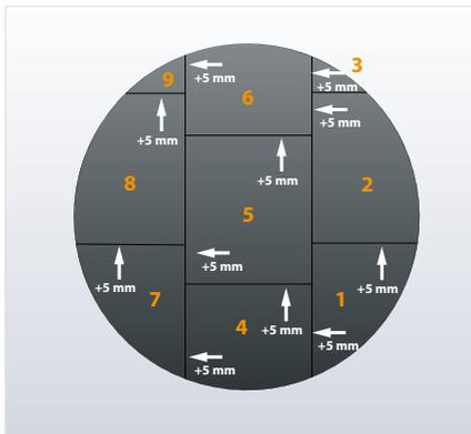
Für den exakten Zuschnitt der Randplatten die Oberkanten der für die Dämmung des Behälterkörpers verwendeten Platten mit weißer Kreide nachziehen.
