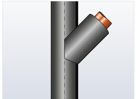
2. An dem Schlauchstück mit  $45^\circ$ -Zuschnitt wie oben gezeigt einen  $22,5^\circ$ -Winkel markieren und zuschneiden.
