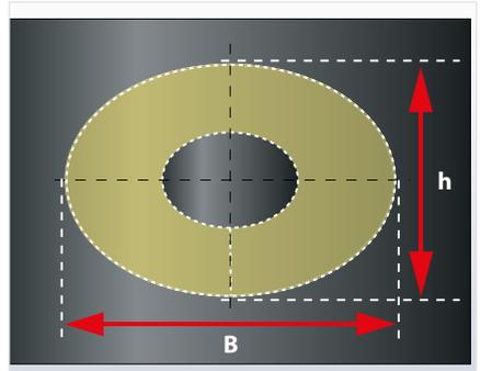
Höhe und Breite des Flansches am Spindelgehäuse messen und eine Stirnscheibe anfertigen.
