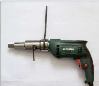
Abb. 3: Festziehen der Spindel und der Klemmmutter
