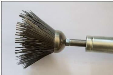
Abb. 5: Glockenbürste auf Spindel geschraubt
