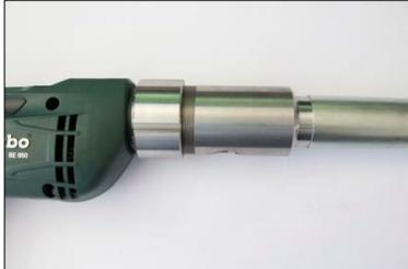
Abb. 4: Führungsrohr auf Vorsatzbuchse
