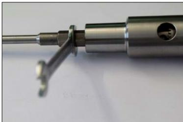
Abb. 11: Lösen der Spindel
