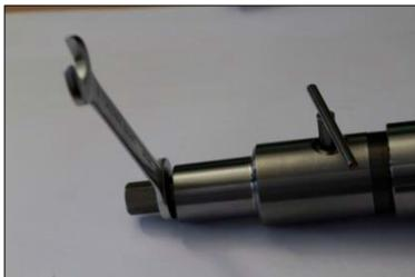
Abb. 12: Lösen der Spindel (13 cm) mit dem Bohrfutterschlüssel
