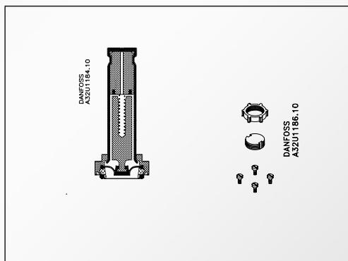
Der Trennmembraneinheit besteht aus montierter Trennmembrane, O-Ring, 4 Schrauben, Sicherungsknopf und Mutter für die Spule.
