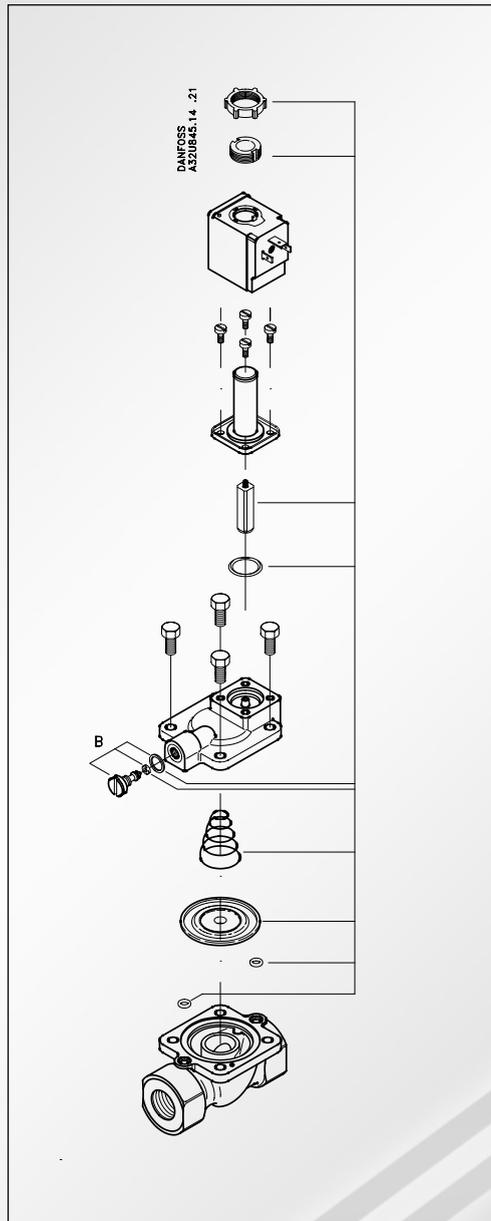
Der Ersatzteilesatz besteht aus Sicherungsknopf und Mutter für die Spule, Anker mit Dichtung und Feder, O-Ring für Ankerrohr, Feder und Membrane, zwei O-Ringen für das Servosystem und einem O-Ring und einer Dichtung für die Ausgleichsdüse.
