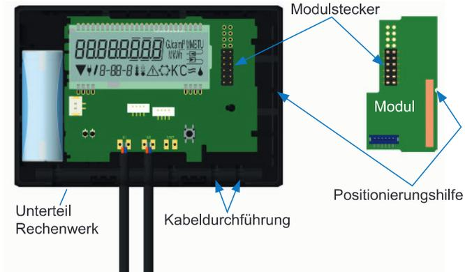
Nach dem Schließen des Rechenwerks muss der Zähler mit der den Modulen beigelegten nummerierten Klebplombe gegen Manipulation gesichert werden (über die zerstörte Plombe kleben). Der Barcode-Aufkleber kann für Dokumentationszwecke genutzt werden.
