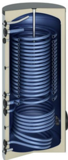
Brauchwasserspeicher mit besonders großer, doppelter Wärmetauscherwendel für eine hohe Wärmeübertragung in Kombination mit Wärmepumpen und einer zusätzlichen Wendel für einen alternativen Wärmeerzeuger.
