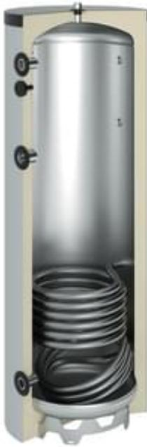
Mit diesem OEG-Pufferspeicher erfüllen Sie höchste Ansprüche an die Wärmespeicherung. Er eignet sich dort, wo Wärmeerzeuger eingesetzt werden, bei denen der optimale Wirkungsgrad erst unter Vollast erreicht wird. Während des Betriebes des Wärmeerzeugers wird mehr Wärme erzeugt als von den Verbrauchern abgenommen wird. Die überschüssige Wärme erhitzt das Wasser des Pufferspeichers und wird somit gespeichert. Später kann dann in Stillstandsphasen diese Wärme bedarfsgerecht abgerufen werden.
