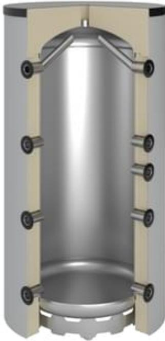
Mit diesem Pufferspeicher erfüllen Sie höchste Ansprüche an eine Wärmespeicherung. Durch seine hocheffiziente Isolierung ist der Warmhalteverlust im Vergleich zu handelsüblichen Speichern deutlich reduziert. Aufgabe des Pufferspeichers ist es eine Differenz zwischen erzeugter und verbrauchter Wärme auszugleichen. Auf diese Weise können die Wärmeerzeuger unabhängiger vom Verbrauch betrieben werden.
