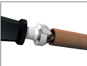
3. Entfernen Sie alle Grate an den Gewinden und Rohren. Grate können zu Undichtigkeit führen und die Gewinde am Kugelhahn beschädigen.
