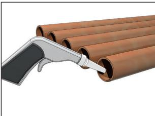
2. Vor der Verwendung von Rohren und Fittings prüfen Sie diese auf Verunreinigungen, Grate und Beschädigungen.
