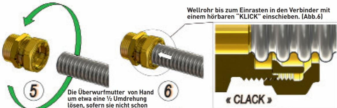
Die Überwurfmutter von Hand um etwa eine 1/2 Umdrehung lösen, sofern sie nicht schon locker ist. (Abb.5)
