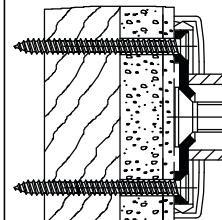
**(FR)** Cloisons légères (type Placo-plâtre avec renfort en bois dur de 20 mm minimum). En cas de double épaisseur de plâtre, des vis plus longues sont nécessaires.
