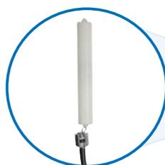
Schwimmende Entnahme nach Empfehlung der DIN 4755. Ermöglicht die Heizölentnahme im sauberen Bereich und unterstützt so die optimale Funktion nachfolgender Armaturen (z. B. Ölfilter).
