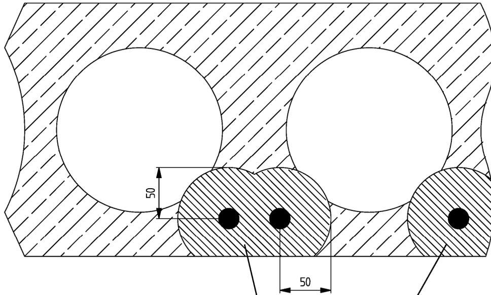
Bereich, in dem kein Dübel gesetzt werden darf.
