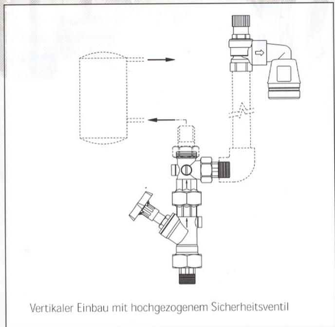
Vertikaler Einbau mit hochgezogenem Sicherheitsventil
