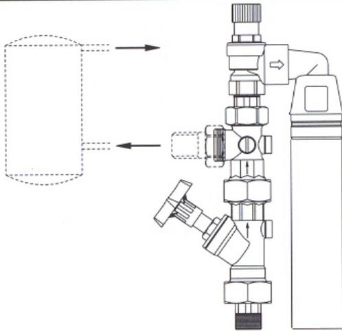
Vertikaler Einbau mit Anschluss eines HT-Ablaufrohres
