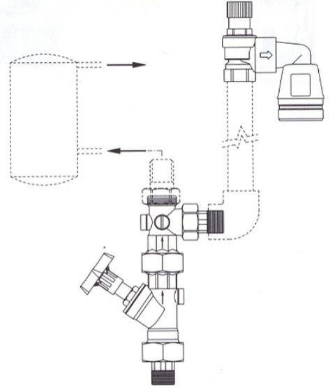
Vertikaler Einbau mit hochgezogenem Sicherheitsventil
