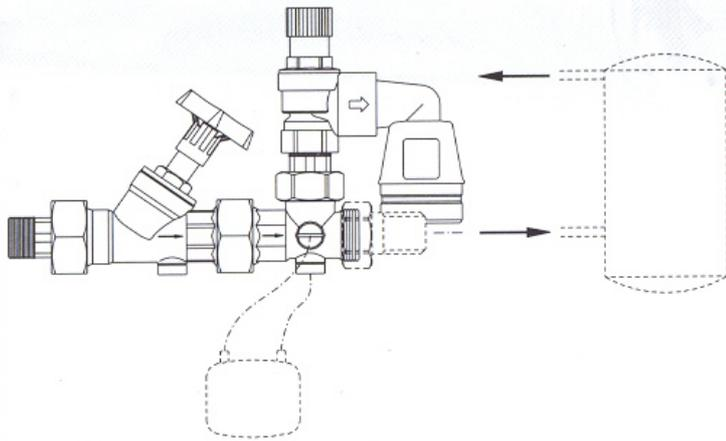
Horizontaler Einbau mit Anschluss eines teildurchströmten Membranausdehnungsgefäßes
