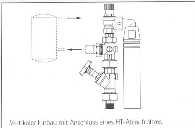
Vertikaler Einbau mit Anschluss eines HT-Ablaufrohres
