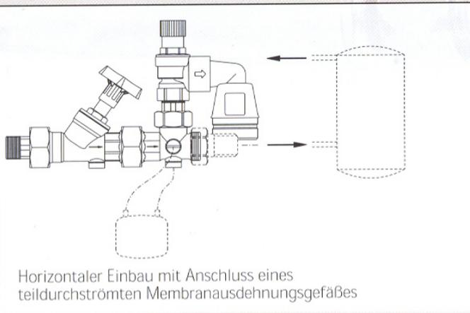
Horizontaler Einbau mit Anschluss eines teildurchströmten Membranausdehnungsgefäßes
