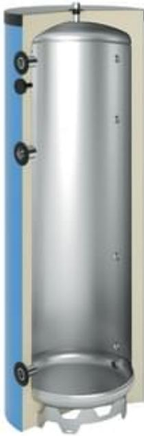
Mit diesem Pufferspeicher erfüllen Sie höchste Ansprüche an eine Wärmespeicherung. Durch seine hocheffiziente Isolierung ist der Warmhalteverlust im Vergleich zu handelsüblichen Speichern deutlich reduziert. Aufgabe des Pufferspeichers ist es eine Differenz zwischen erzeugter und verbrauchter Wärme auszugleichen. Auf diese Weise können die Wärmeerzeuger unabhängiger vom Verbrauch betrieben werden.
