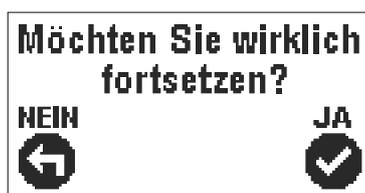
Der Regler verlangt eine Bestätigung der Drehrichtung mit der Taste **✓**. Haben Sie versehentlich den falschen Drehrichtung eingestellt, kehren Sie mit der Taste **←** zur erneuten Einstellung zurück.
