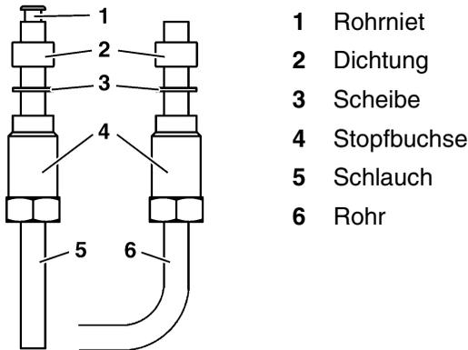
5. Messleitung in den Anschlussstutzen bis zum Anschlag einführen.
