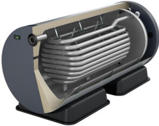
Der Aufbau dieser Speicher unterscheidet sich grundsätzlich von üblichen, großvolumigen Brauchwasserspeichern. Ein eingebautes Edelstahlwellrohr trennt das Trink- vom Heizwasser und dient gleichzeitig als leistungsstarker Wärmetauscher. Dadurch werden die Vorteile eines Pufferspeichers mit denen eines Durchlauferhitzers kombiniert.
