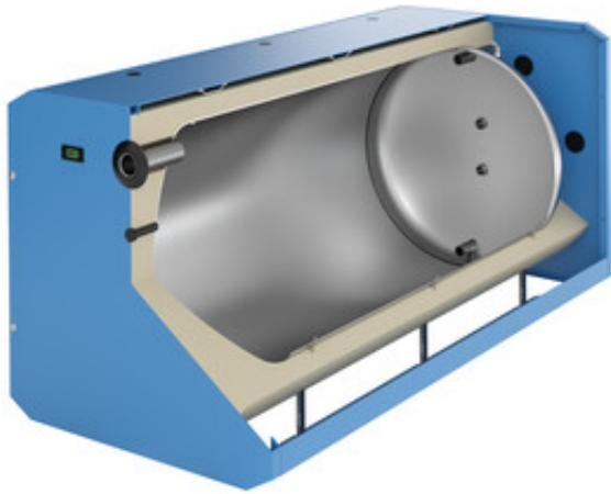
Liegender Pufferspeicher als Unterstellspeicher für Öl- und Gasbrennwertkessel nahezu aller Hersteller. Die stabile Konstruktion erlaubt Belastungen bis 500 kg. Die konkurrenzlose OEG-Vakuum-Isolierung der Speicher hat wesentlich geringere Wärmeverluste als die Isolierung marktüblicher Speicher.
