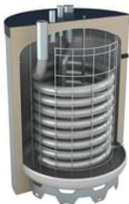
Der Aufbau der OEG Frischwasserspeicher unterscheidet sich grundsätzlich von üblichen, großvolumigen Brauchwasserspeichern. Ein eingebautes Edelstahlwellrohr trennt das Trink- vom Heizwasser und dient gleichzeitig als leistungsstarker Wärmetauscher. Dadurch werden die Vorteile eines Pufferspeichers mit denen eines Durchlauferhitzers kombiniert.
