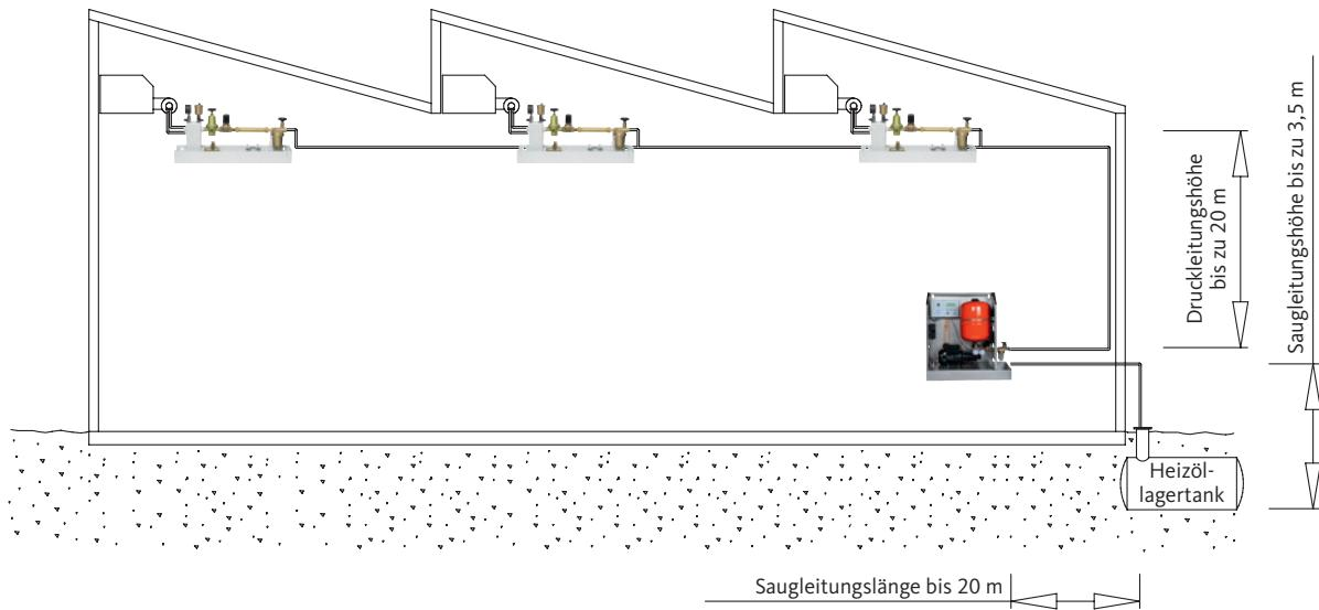
Sollten die Druckspeicheraggregate in Anlagen eingesetzt werden, wo eine sehr hohe Ausfallsicherheit benötigt wird (z.B.: Krankenhäusern, Produktionsbetrieben etc.), empfiehlt es sich, ein zweites Aggregat parallel einzubauen um eine höhere Anlagensicherheit zu gewährleisten.
