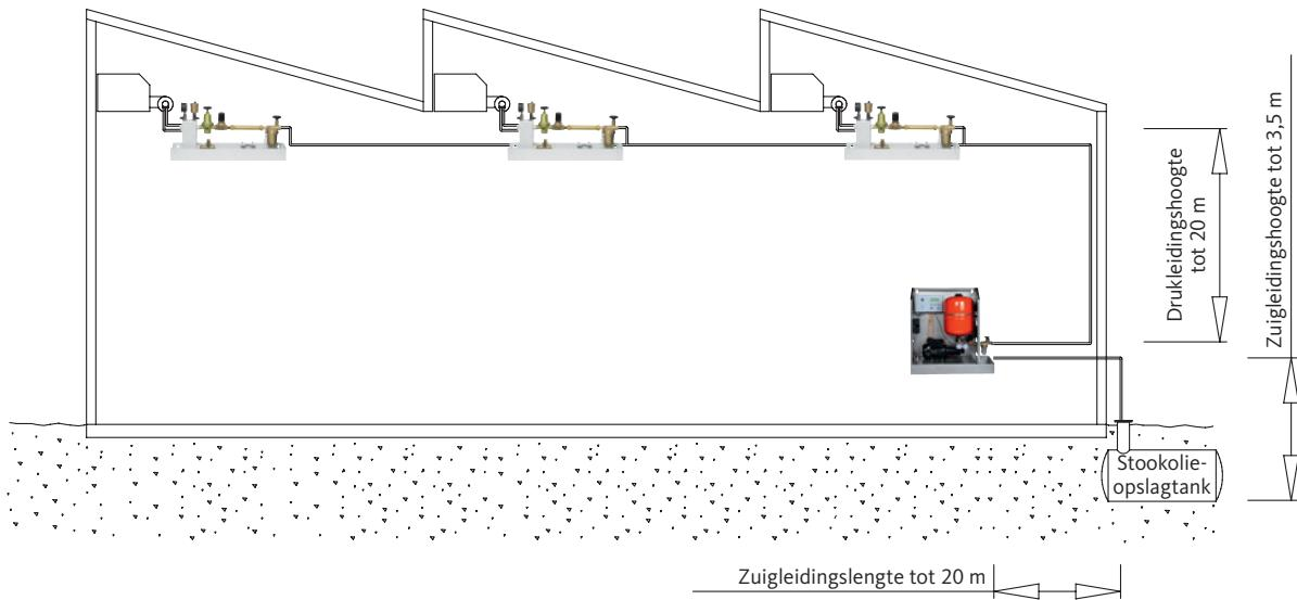
Als de druktankaggregaten worden gebruikt in systemen waar een hoge mate van betrouwbaarheid vereist is (bijv. ziekenhuizen, productie-installaties, enz.), wordt het aanbevolen om een tweede eenheid parallel te installeren om een grotere veiligheid van de installatie te garanderen.
