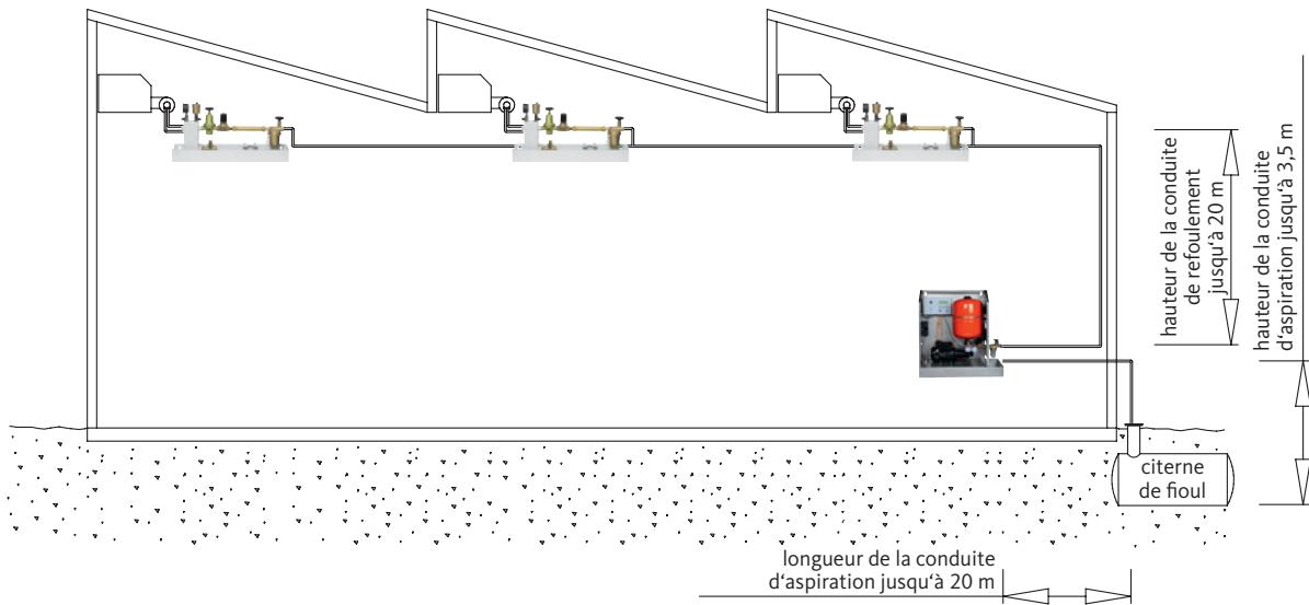
Si les systèmes accumulateurs de pression doivent être utilisés dans des installations nécessitant une très grande fiabilité (p. ex. hôpitaux, sites de production, etc.), il est recommandé d'installer une deuxième unité pompe-moteur en parallèle afin de garantir une plus grande sécurité de l'installation.
