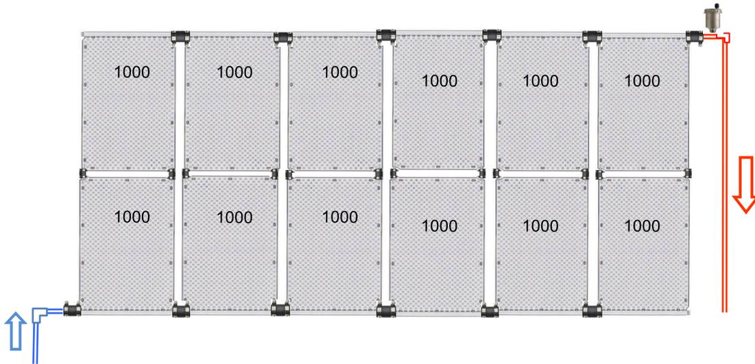
OKU-Absorber Art. N° 1002, in einer Reihe parallel montiert
