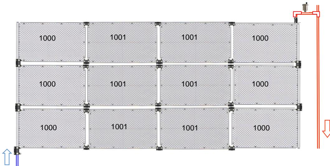
OKU-Absorber Art. N° 1000 und 1001 mehrere Reihen parallel senkrecht montiert
