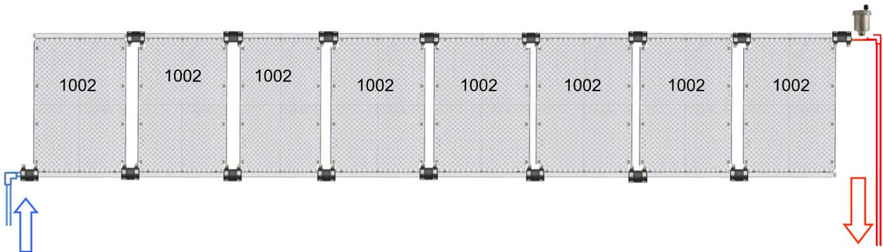
OKU-Absorber Art. N° 1002, in mehreren Reihen parallel montiert
