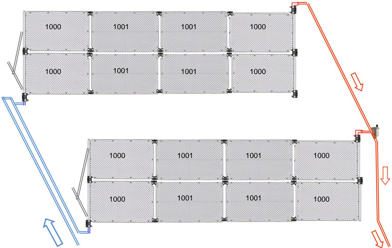
**OKU-Absorber auf 2 Dachseiten, nur bis Dachneigung 15° empfehlenswert**
