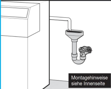
**KESSEL-Rückstaudoppelverschluss Staufix® Siphon DN 50
