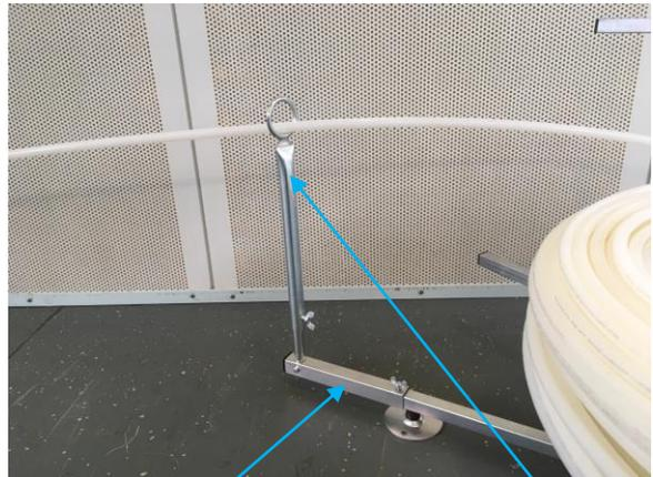
Detail Rohrrichtadapter mit Rohrführungsauge
