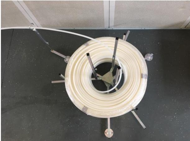
Abwicklung von innen: Zentrierdorne auf kleinsten Innendurchmesser (ca. 290 mm) eingestellt und Haltearme auf Auflagearme schieben, bis sie von außen das Rohrcoil zentrisch halten
