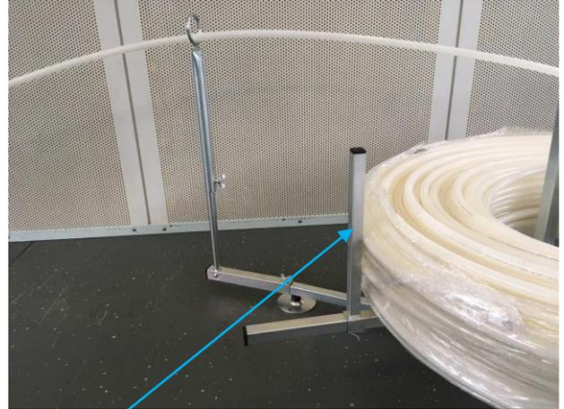
Detail Haltearm und Rohrleitadapter mit Rohrführungsauge
