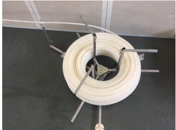
Abwicklung von außen mit im Bild 1 gezeigten optionalen Anbauteilen
