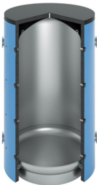
Mit diesem Pufferspeicher erfüllen Sie höchste Ansprüche an eine Wärmespeicherung. Durch seine hocheffiziente Isolierung ist der Warmhalteverlust im Vergleich zu handelsüblichen Speichern deutlich reduziert. Aufgabe des Pufferspeichers ist es eine Differenz zwischen erzeugter und verbrauchter Wärme auszugleichen. Auf diese Weise können die Wärmeerzeuger unabhängiger vom Verbrauch betrieben werden.
