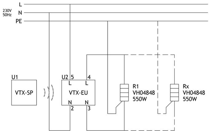
Abbildung 6: Schaltschema VTX-EU mit Heizelement und VTX-SP
