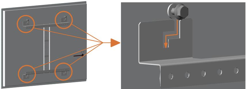
5. Schrauben Sie das Heizelement in dem Wandhalter mit einem Schraubenschlüssel (Schlüsselweite 10 mm) fest.
