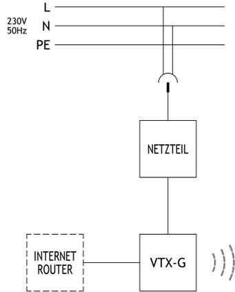
Abbildung 8: Schaltschema VTX-G
