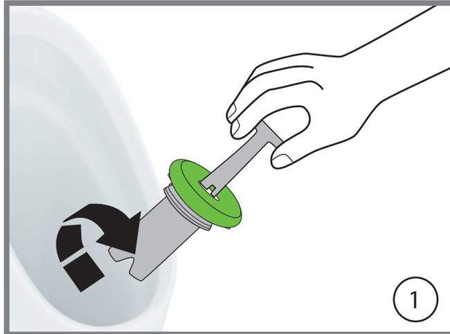
1. Um das Urinal zu reinigen, entfernen Sie den Geruchsverschluss (RV06067). Stecken Sie den Service-Schlüssel (RV05967) in den Geruchsverschluss. Drehen Sie ihn gegen den Uhrzeigersinn aus dem Urinal.
