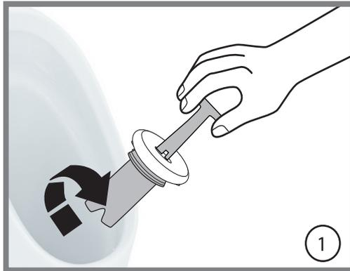
1. Stecken Sie den Service-Schlüssel (RV05967) in den Geruchsverschluss (RV06067). Drehen Sie den Geruchsverschluss gegen den Uhrzeigersinn aus dem Urinal und entsorgen Sie diesen mit dem normalen Hausmüll.
