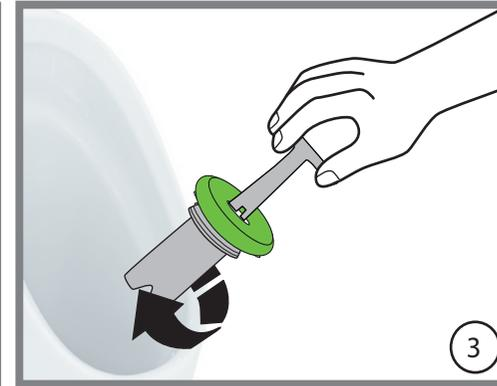
3. Stecken Sie den Service-Schlüssel in den neuen Geruchsverschluss und schrauben Sie diesen im Uhrzeigersinn in das Urinal.
