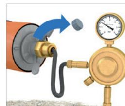
Falls Du trotzdem nochmal an das Rohr musst, so kannst Du das angestaute Wasser kontrolliert ablassen oder die Öffnung für eine Druckprüfung bis 0,5 bar benutzen. Fertig!
