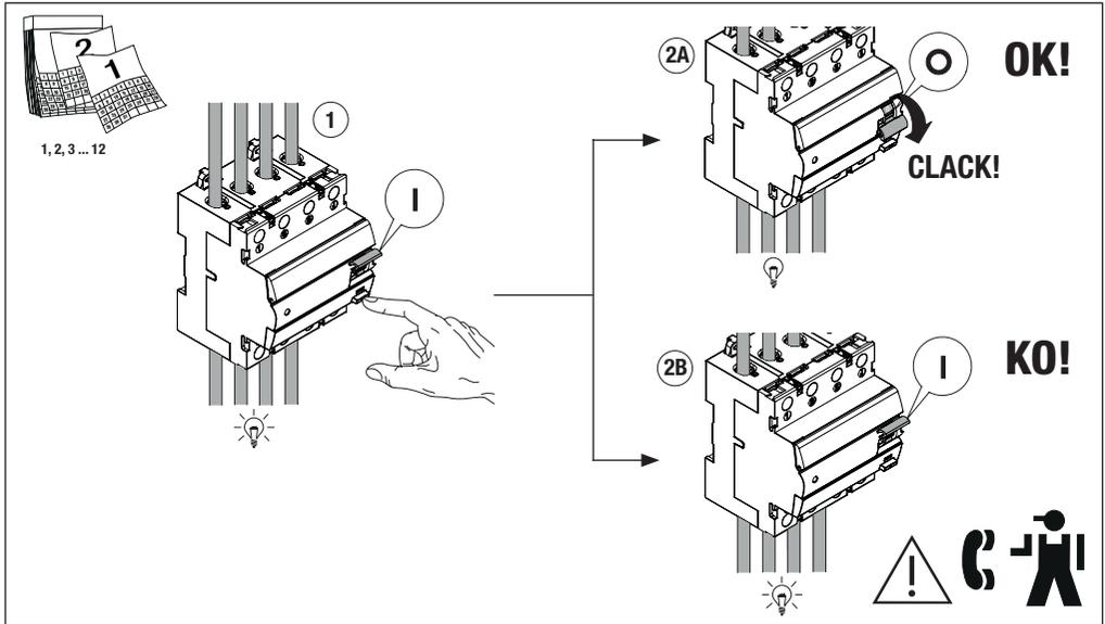
**VERIFICA DI ISOLAMENTO DEL QUADRO - DISTRIBUTION BOARD INSULATION TEST -**
