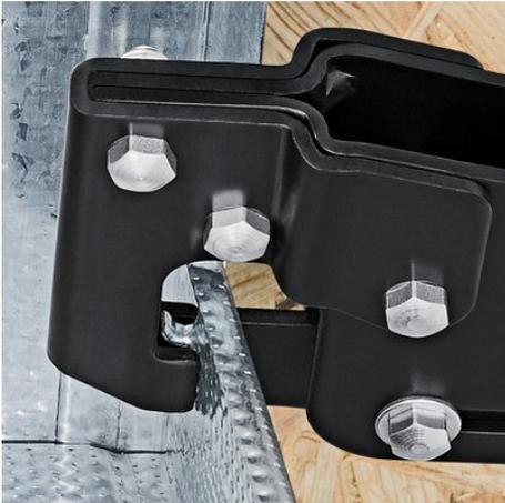
Das Stempelwerkzeug wird durch die Profilbleche gedrückt
