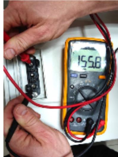
Wenn die gemessene Spannung erheblich vom Nennwert abweicht, überprüfen Sie bitte die elektrische Spannung an den einzelnen Modulen wie folgt:
