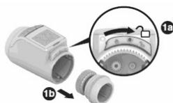
5. Ventilaufsatz auf Ventil schrauben. Wenn nötig, Adapter verwenden
