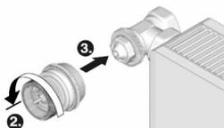
6. Ventilaufsatz mit Regler verbinden
