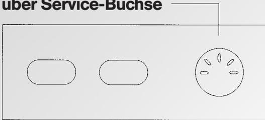
Die 5-polige Service-Buchse dient zu Programmierzwecken über das Raumgerät RS-10 (RS-20) bzw. über Laptop. Bei letzterem kann auf Anforderung eine entsprechende Hard- und Software zur Verfügung gestellt werden.
