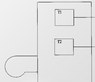
Einschalten des Brenners, wenn die obere Meßstelle T 1 eine Kesseltemperatur von 57 °C erfaßt.
