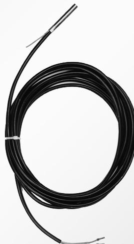
Der Temperaturfühler KVT 20 ist als Tauchfühler mit angegossenem Kabel ausgebildet und dient zur Erfassung der Kessel- und Warmwassertemperatur. Beim Kessel erfolgt die Einbringung in die Tauchhülse zusammen mit den Fühlerelementen des Sicherheitstempereaturbegrenzers (STB), des Kesseltemperaturreglers (KTR) und der Kesseltemperaturanzeige (KTA). Die im Fühler eingearbeitete Spannfeder sorgt für den erforderlichen Anpreßdruck.
