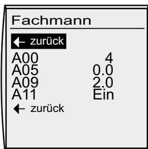
Einstellung der Anlagenparameter der Heizungsregelung . Einstellmöglichkeiten und Erklärung zu den einzelnen Parametern stehen im Kapitel **Anlagenparameter-Überblick**.
