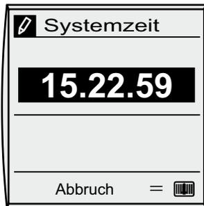
Rechten Drehknopf drücken um in die 2. Bedienebene zu wechseln. Durch Drehen des rechten Drehknopfs im Uhrzeigersinn die Menüebene „Grundeinstellung“ anwählen und durch erneutes Drücken des rechten Drehknopfs die Auswahl bestätigen.
