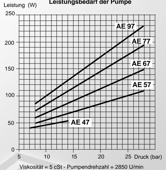
Viskosität = 5 cSt - Pumpendrehzahl = 2850 U/min
