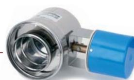
**Typenreihe MUK 80/125, MUK 100/150** Für Abgasanlagen nach DVGW-Arbeitsblatt G 635 (LAS-Überdruck), Klappensegel mit aufgespritzter EPDM-Dichtung, bis 140° C. Druck- und kondensatdichte Wellendurchführungen.
