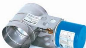
**Typenreihe MUK** Für Geräte ohne Zündflamme mit Kondensatanfall oder Kaskadenanlagen, metallisch dichtschließend, kondensatbeständig, für Über- und Unterdruck-Abgasanlagen bis 200° C. Bei Ausführung mit Dichtlippe bis max. 140° C. Mit druck- und kondensatdichter Wellendurchführung.
