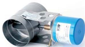
**Typenreihe MOK... AD** Für Geräte ohne Zündflamme, ohne Kondensatanfall, metallisch dichtschließend für Unterdruck-Abgasanlagen, bis 400° C. Gehäuse bis Ø 300 mm in steckbarer Ausführung.
