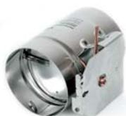
**Typenreihe MOK** Für Geräte mit Zündflamme und Festbrennstoffe mit Mindestöffnung für Unterdruck-Abgasanlagen. Für Abgastemperaturen bis 400° C.
