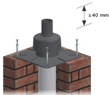
Abdeckplatte fest dübeln. Bei Bedarf den Kopf mit einer Betonabdeckung verstärken!
