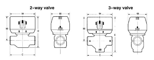
Fig. 9. Valve dimensions
