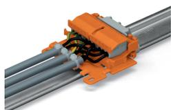
Liegende Montage mit Zugentlastungsplatte auf Tragschiene 35 mittels Universalwinkeladapter
