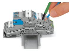
Leiter mit Betätigungswerkzeug anschließen. Beim Anschluss unbehaltener feindrähtiger Leiter oder kleiner Querschnitte, die ein direktes Stecken nicht zulassen, wird zum Öffnen der Klemmfeder, wie bei CAGE CLAMP® gewohnt, das Betätigungswerkzeug aus der Vertikalen in die Betätigungsöffnung gesteckt.
