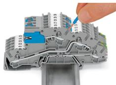
Leiter anschließen – direkt stecken. Eindrähtige Leiter lassen sich bis zu einem Querschnitt über und mindestens zwei Querschnittstufen unter dem Nennquerschnitt direkt stecken, ohne Werkzeug.
