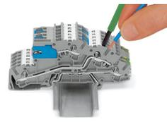
Leiter mit Betätigungswerkzeug anschließen. Beim Anschluss unbehandelter feindrähtiger Leiter oder kleiner Querschnitte, die ein direktes Stecken nicht zulassen, wird zum Öffnen der Klemmfeder, wie bei CAGE CLAMP® gewohnt, das Betätigungswerkzeug aus der Vertikalen in die Betätigungsöffnung gesteckt.
