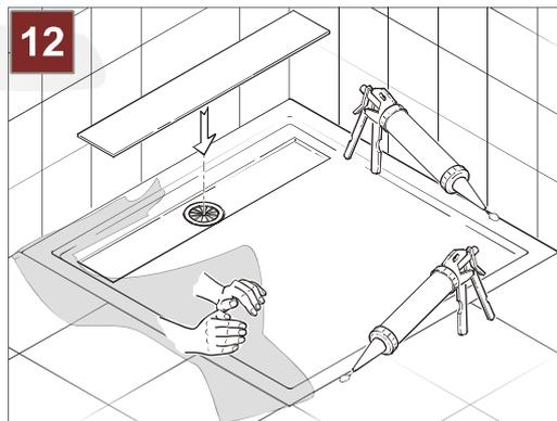
12. Nach Austrocknung der Fugenmasse wird die Schutzabdeckung von der Duschwanne abgenommen und die Anschlussstellen Dusche-Wand-Boden werden mit Silikon verdichtet.
