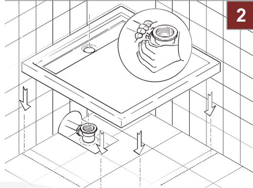
2. Das Siphongehäuse wird mit dem Abwasserrohr verbunden.
