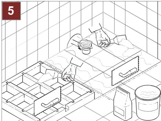
5. Auf beide Oberflächen (Untergrund und Unterseite des Trägers) wird Kleber (Flex-Fliesenkleber) mit Zahnpachtel aufgetragen.
