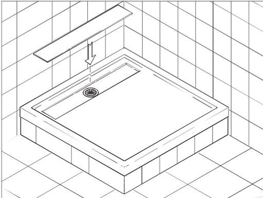
**Variante II:** Montage mit Hartschaumträger. Bei dieser Montage ist keine Vertiefung im Untergrund notwendig. Duschwanne mit Träger ist ca. 160-175mm (je nach Modell) hoch.
