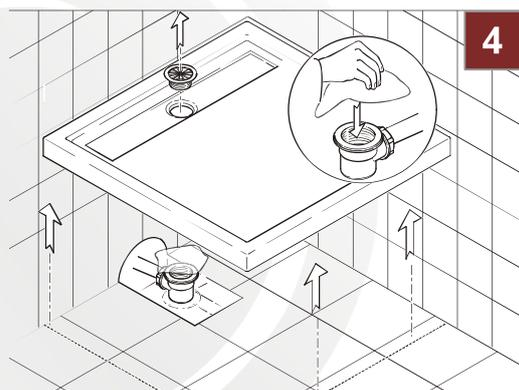
4. Ablaufdeckel/Verschraubung wird wieder entfernt und die Duschwanne zur Seite gestellt. Das Siphongehäuse bleibt montiert und die Öffnung wird gegen Verschmutzung abgedeckt.
