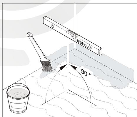
**ANMERKUNG!** Bei Wandverfliesung auf den Wannrand muss das geringere Aufstellmaß für die Duschkabine beachtet werden. Dies sollte vorher unbedingt geprüft und ggf. die Einbauweise (Wandverfliesung) geändert werden.
