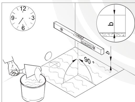
b=Vertiefung im Boden=ges. Höhe des Trägers mit der Duschwanne
