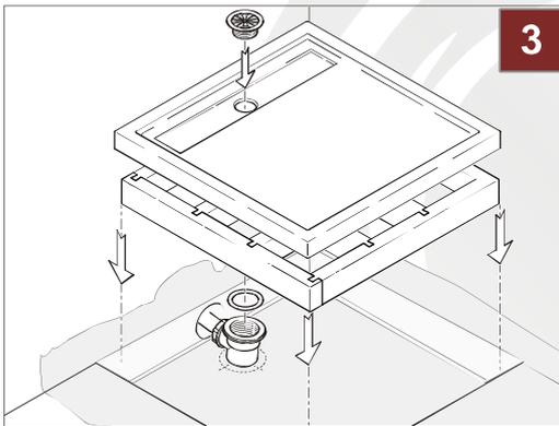
**3.** Beachten Sie die korrekte Isolierung geg. Nässe im ges. Spritzwasserbereich und der Aufstellfläche. Die Anschlussstelle des Trägers/der Duschwanne zur Wand soll mit Trittschalldämmstreifen isoliert werden.
