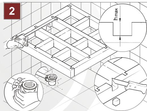
2. Im Träger wird das Siphongehäuse in der entsprechenden Aussparung positioniert und mit dem Abflussrohr verbunden. Der Träger kann an der erforderlichen Stelle zugeschnitten werden. Die Trägerhöhe ist so festgelegt, dass das Siphongehäuse komplett im Träger plaziert werden kann.
