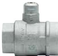
**SWIFT•O•MATIC® QM** Kugelhähne haben eine von unten montierte Bedienungsspindel. Dieses System wird als "ausblässicher" bezeichnet, da es einen größeren Schutz vor dem ungewollten Herausrutschen der Spindel und des entsprechenden Dichtungssystems bietet. Ausserdem kann es nicht versehentlich von aussen beschädigt werden.
