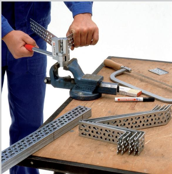
Bei der Fertigung einer Wandkonsole, müssen Sie einen Winkel von  $135^\circ$  biegen. Dieses erreichen Sie, wenn Sie die Biegezanze in den Schraubstock spannen oder den linken Griff der Biegezanze versetzen!
