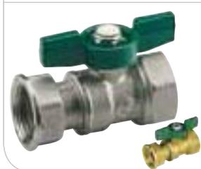
► Kugelhahn mit grünem Flügelgriff, **Wasserzähleranschlussverschraubung** und IG/IG. Messing oder Messing verchromt. Für Heizung oder Trinkwasser. Verplombung möglich.
