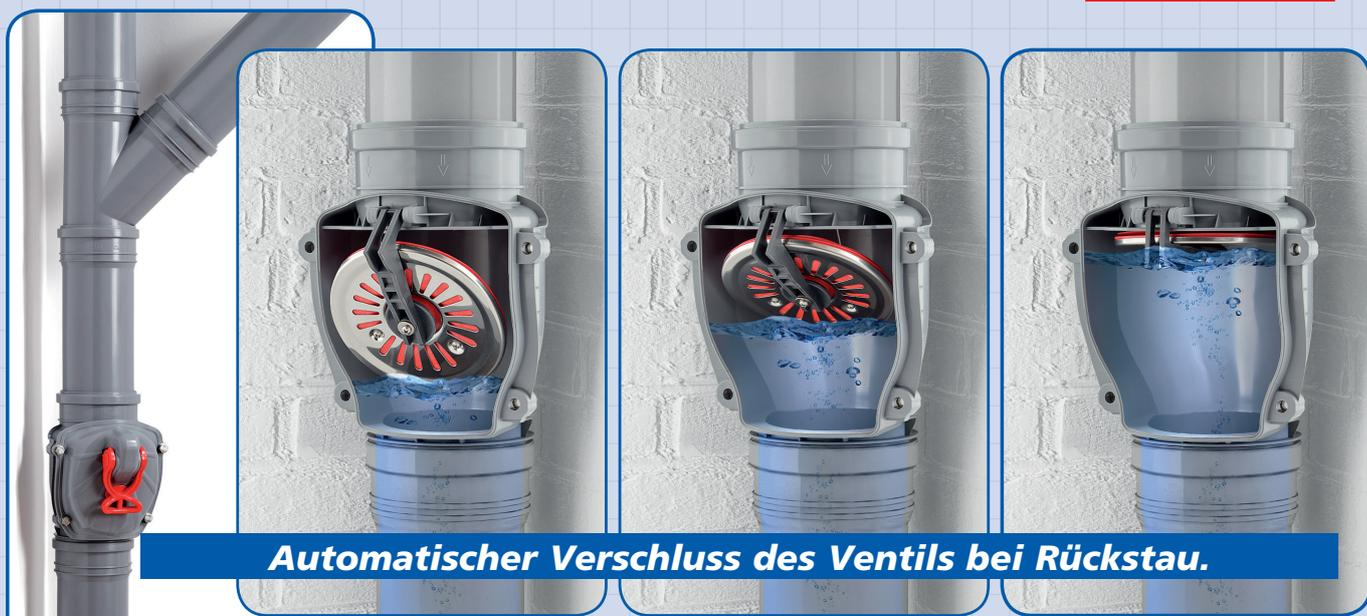
**Automatischer Verschluss des Ventils bei Rückstau.**
