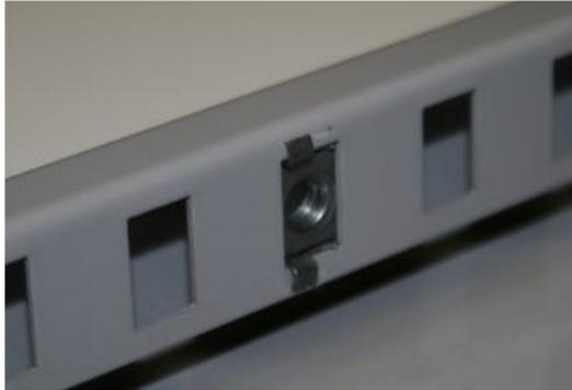
Um Regalwannen, Universaltraversen, Adapter für Schubläden, Schwerlasttraversen, Sperrbalken oder einzelne Klappen in den Seitenteilen befestigen zu können, ist es notwendig, an den entsprechenden Positionen der Vierkantlochungen auf den Innenseiten der Vorder- und Rückkante der Seitenteile die, den Bauteilen beigelegten Käfigmuttern zu setzen.
